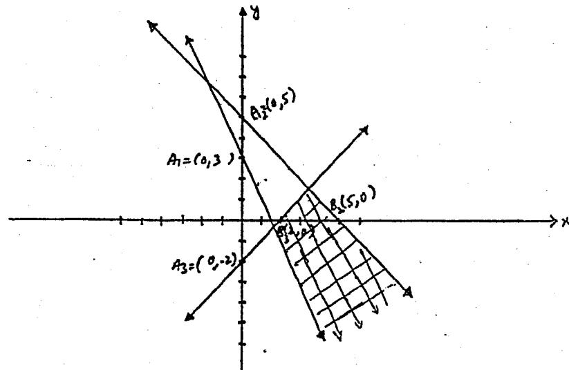
Now  $2x+y \geq 3$ ,  $x+y \leq 5$ ,  $x-y \geq 2$
